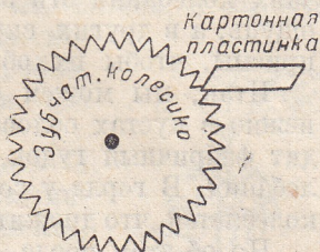
Рис. 4. Получение звука при помощи зубчатого колесика и картонной пластинки.
