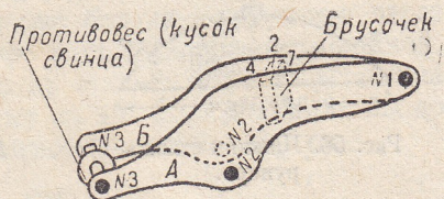
Рис. 54. Держалка рупора-мембраны в собранном виде.
