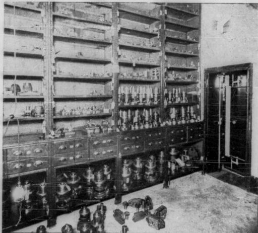
46. Одно изъ многихъ отдѣленій со стальными полками, гдѣ сохраняются орудія къ автоматическимъ машинамъ, изготовляющимъ части механизмовъ аппаратовъ „ПИЩУЩИЙ АМУРЪ“.
