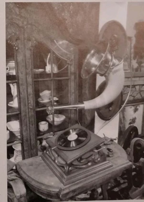
Натурофон В. И. Ребикова Гнутый рупор, наклонный диск – изобретение Ребикова
